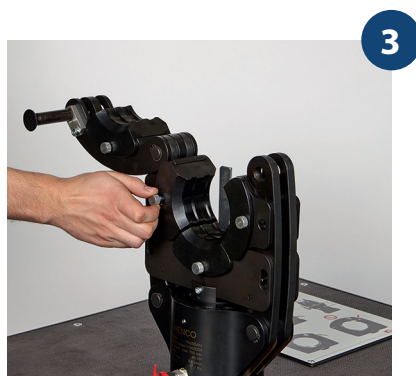
3. Fixer l'insert (diamètre 75 ou 90) dans la chaîne de sertissage avec les boulons à épaulement appropriés
