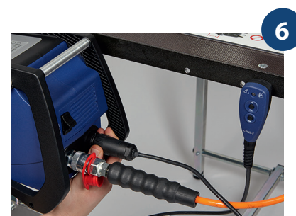
6. Raccorder la télécommande à l'arrière de la pompe (appuyer & tourner)
