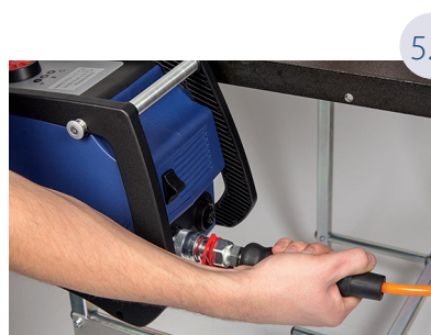
5.1 Raccorder le côté mâle du tuyau hydraulique à l'arrière de la pompe
