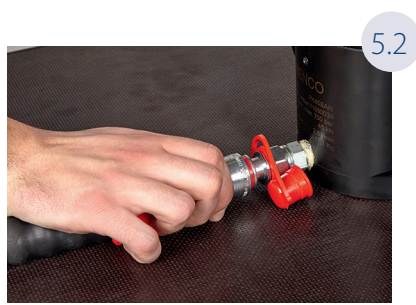
5.2 Raccorder le côté femelle du tuyau hydraulique à la chaîne de sertissage
