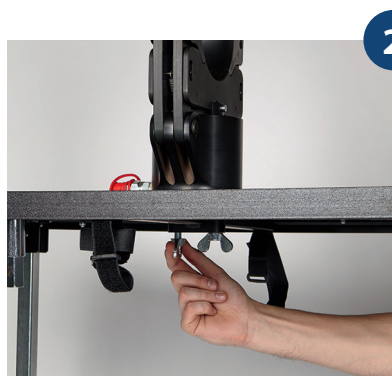
2. Poser la chaîne de sertissage sur la tôle et la fixer par dessous avec les deux boulons ailés
