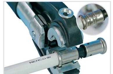
3. Insérez le tube dans le raccord jusqu'à la butée, de manière à ce que le tube colore les fenêtres d'observation complètement en blanc. Ouvrez ensuite la mâchoire de la presse Henco, placez correctement le bord de guidage du tube en acier inoxydable dans la mâchoire de la presse et sertissez.
