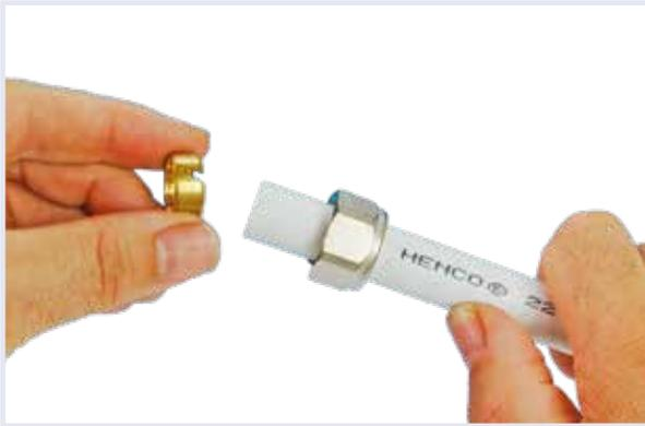
Schieben Sie die Mutter und danach den Klemmring über das Rohr. Damit die Mutter besser gleitet, können Sie sie eventuell mit Silikonöl einfetten. Niemals Mineralöl verwenden!
