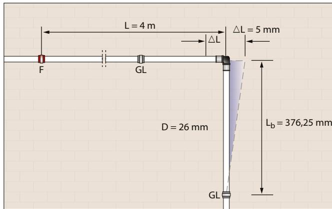
Ein Rohr mit einem Durchmesser von 26 mm und einer Länge von 4 m das die Richtung ändert, erfordert bei einem Temperaturunterschied von 50°C, einen 376,25 mm langen Biegeschenkel, um die Temperatur bedingte Längenänderung aufnehmen zu können.
