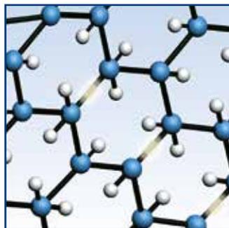
Die Querverbindungen reduzieren die Bewegung der Molekülketten untereinander auf ein Mindestmaß. Das Rohr wird sich nun dank seiner starken Struktur nicht mehr verformen, wenn es Wärme oder einer anderen Energieform ausgesetzt wird. Vernetztes Polyethylen ist hoch temperatur- und druckbelastbar. Die Vernetzung sorgt für eine sehr hohe **Beständigkeit**.
