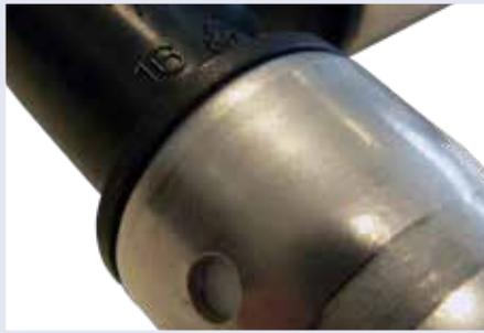
1. Prüfen Sie den  $\varnothing$  der Pressverbindung.
