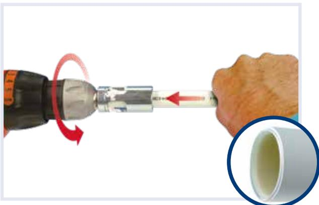
Wenn das Rohr korrekt kalibriert ist (zentrieren, abgeschragt, lackiert), ist die Abschrägung der Innen- und Außenseite des Rohres vollständig rundherum sichtbar.
