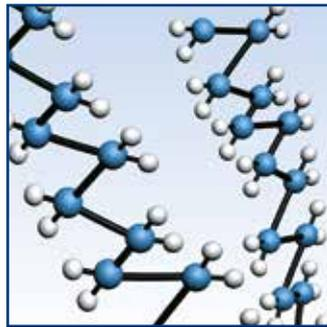
Polyethylen ist ein Kunststoff, der aus mehreren Molekülketten besteht. Diese Ketten sind nicht direkt miteinander verbunden. Die Basisstruktur wird durch schwache wechselseitige Kräfte zwischen den Molekülen zusammengehalten. Bei Erwärmung bewegen sich die Polyethylen-Molekülketten immer weiter auseinander. Dadurch wird das Material weicher, elastischer und weniger druckbelastbar. Kurzum, es eignet sich weniger gut für die Anwendung in Sanitär- oder Heizungsanlagen.
