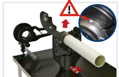
Legen Sie das Fitting in die Pressbacke und achten Sie darauf, dass es am Aluminium-Positionierungsanschlag anliegt. Dann führen Sie das Rohr soweit in das Pressfitting ein, bis die Kontrollfenster die Farbe des Rohres aufweisen. Das Fitting kann nun durch Betätigung der Hydraulikpumpe verpresst werden.
