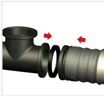
Legen Sie den Dichtungsring in den Zentrierring bevor Sie das verpresste Rohr mit dem Fitting verbinden.
