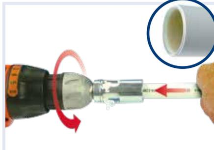
Verwenden Sie das Kalibriergerät Henco Kalispeed, um das Rohr zu zentrieren und an der Innen- und Außenseite abzuschrägen.
