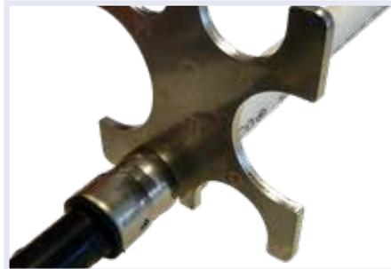
5. Drehen Sie das Messgerät 360° um die Druckstelle der Presshülse und achten Sie darauf, dass beide bei diesem Vorgang perfekt aneinander anschließen, wie in Schritt 4. Falls dies nicht möglich ist (z.B. zu große Entfernung, ein Hindernis, ...) stimmt etwas mit dem Pressen der Koppelung nicht. Wenn dies der Fall ist, empfehlen wir Ihnen, eine vollständig neue Druckverbindung herzustellen und sowohl die Pressmaschine als auch die Pressbacke zu kontrollieren.
