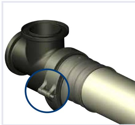
Schieben Sie die beiden Enden ineinander und legen Sie die Klammer über die Schultern beider Fittings.
