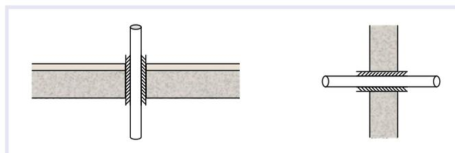
Für Wand- und Bodenpassagen empfehlen wir, ein Stück Isolierung um das Rohr zu schieben, um das Rohr zu schützen.
