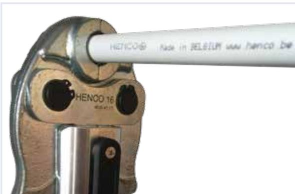
Nach dem Verpressen die Pressbacken öffnen und prüfen, ob das Rohr noch bis zum Anschlag montiert ist, so dass die Kontrollfenster die Farbe des Rohres vollständig angenommen haben.
