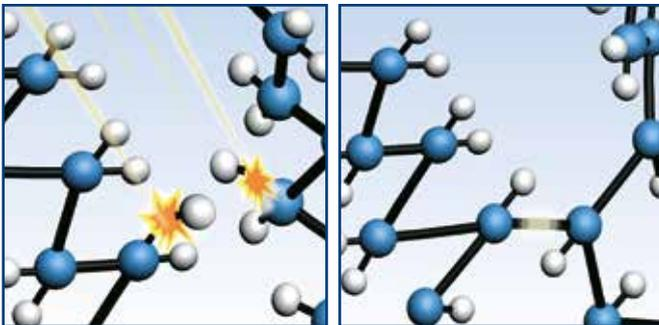
Indem man das Verbundrohr einer intensiven Elektronenbestrahlung aussetzt, fördert man die Entstehung von **Querverbindungen** zwischen den einzelnen Molekülketten des Kunststoffs. Die Elektronen sorgen dafür, dass sich die Wasserstoffatome von den einzelnen Polyethylenketten abspalten. Dadurch können sich die Kohlenstoffatome aneinander binden und so eine starke, vernetzte Struktur bilden.
