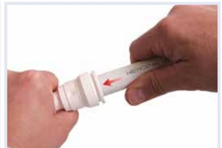
Entfernen Sie die schwarze Schutzkappe und schieben Sie das Rohr bis zum Anschlag in das Fitting, so dass die Farbe des Rohres im Sichtfenster sichtbar ist.
