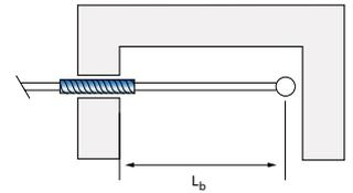
Wenn der Schacht groß genug ist und genügend Platz für die Montage des errechneten Biegeschenkels bietet, reicht eine Ummantelung des Rohres am Wanddurchgang generell aus.
