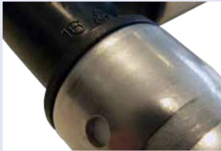
1. Prüfen Sie den  $\varnothing$  der Pressverbindung.
