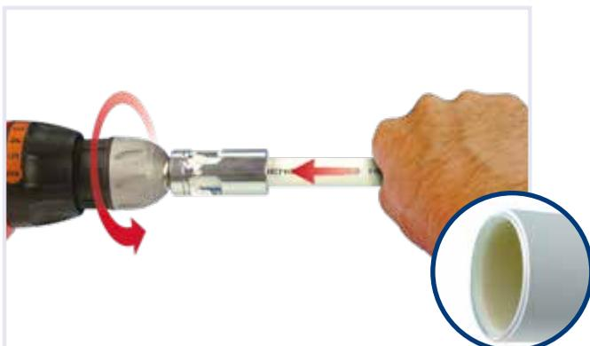
Wenn das Rohr korrekt kalibriert ist (zentrieren, abgeschragt, lackiert), ist die Abschrägung der Innen- und Außenseite des Rohres vollständig rundherum sichtbar.
