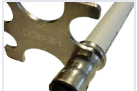
*ACHTUNG! Das PRESSCHECK Messgerät kommt nur zur Anwendung bei Pressfittings, die mit dem Henco Profil (BE Profil) oder dem TH Profil (bis  $\varnothing 26$ ) hergestellt sind, in Kombination mit einem Henco PVDF oder Messing Pressfitting.*
