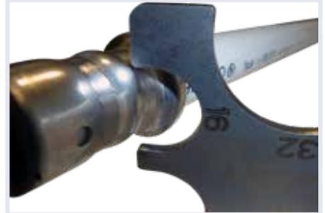
3. Legen Sie die entsprechende Aussparung des Messgerätes auf die Druckstelle, die sich auf der Presshülse befindet.
