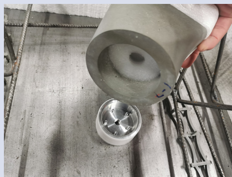
Plaatsen van het betonelement over de magneet.
